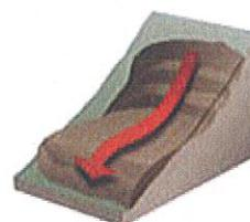
**Le glissement à surface de rupture circulaire se produit généralement dans des matériaux homogènes**
